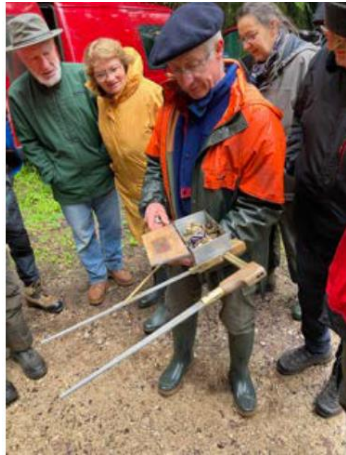
Compass enregistreur inventé et utilisé par l'un des membres historiques de la société du contrôle au début du XXème siècle.
